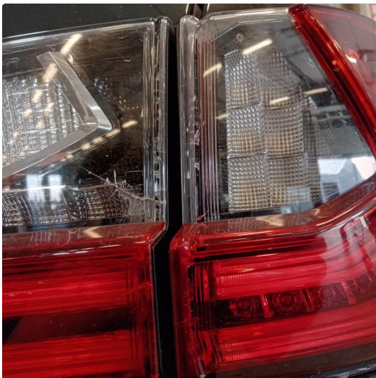
2.1 Krakelert lykter. VURDERES OM NOEN MÅ BYTTES.
