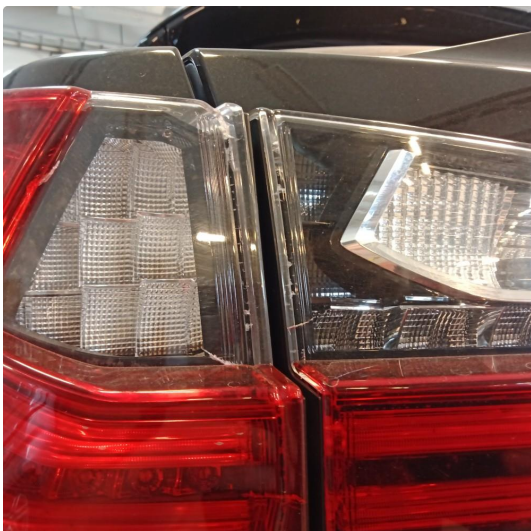
2.1 Krakelert lykter. VURDERES OM NOEN MÅ BYTTES.
