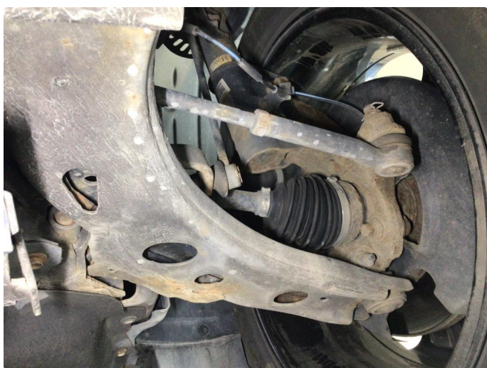
2.1 Overflaterust i forstilling, ingen tiltak kreves
