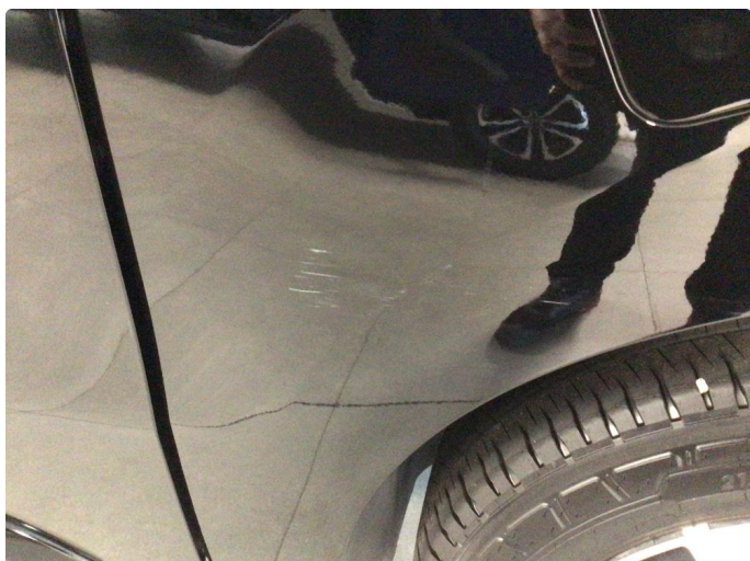
2.1 Noe overfladiske riper rundt på bil, dette blir å anse som normal bruksslitasje
