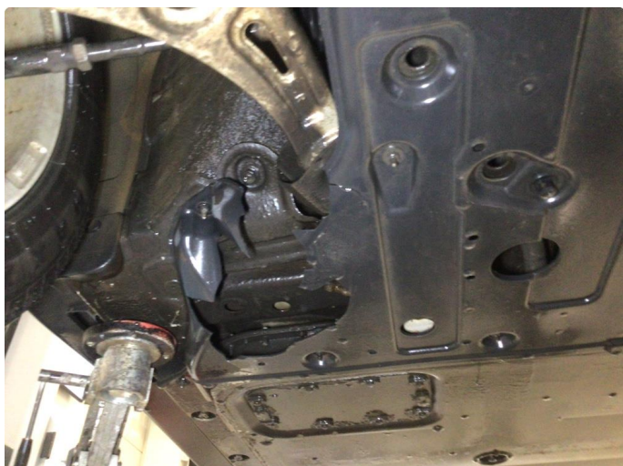
1.1 En beskyttelsesplate under bil er sprukket
