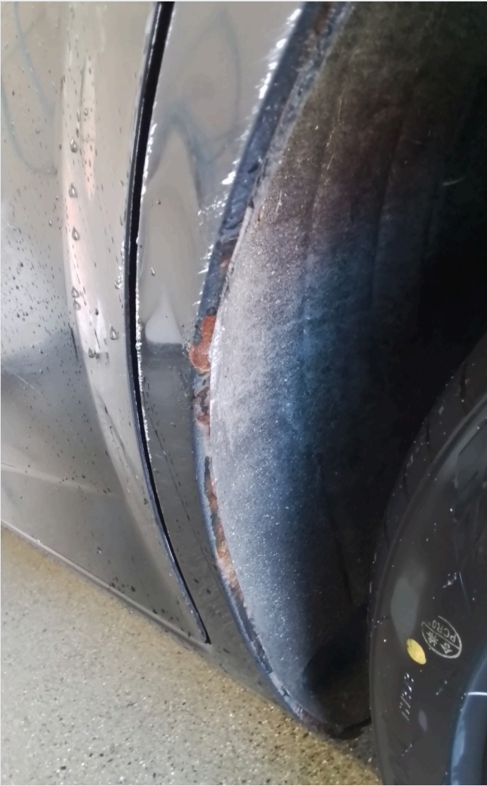
2.1 Noe rust i hjulbuer og nedre del av dører
