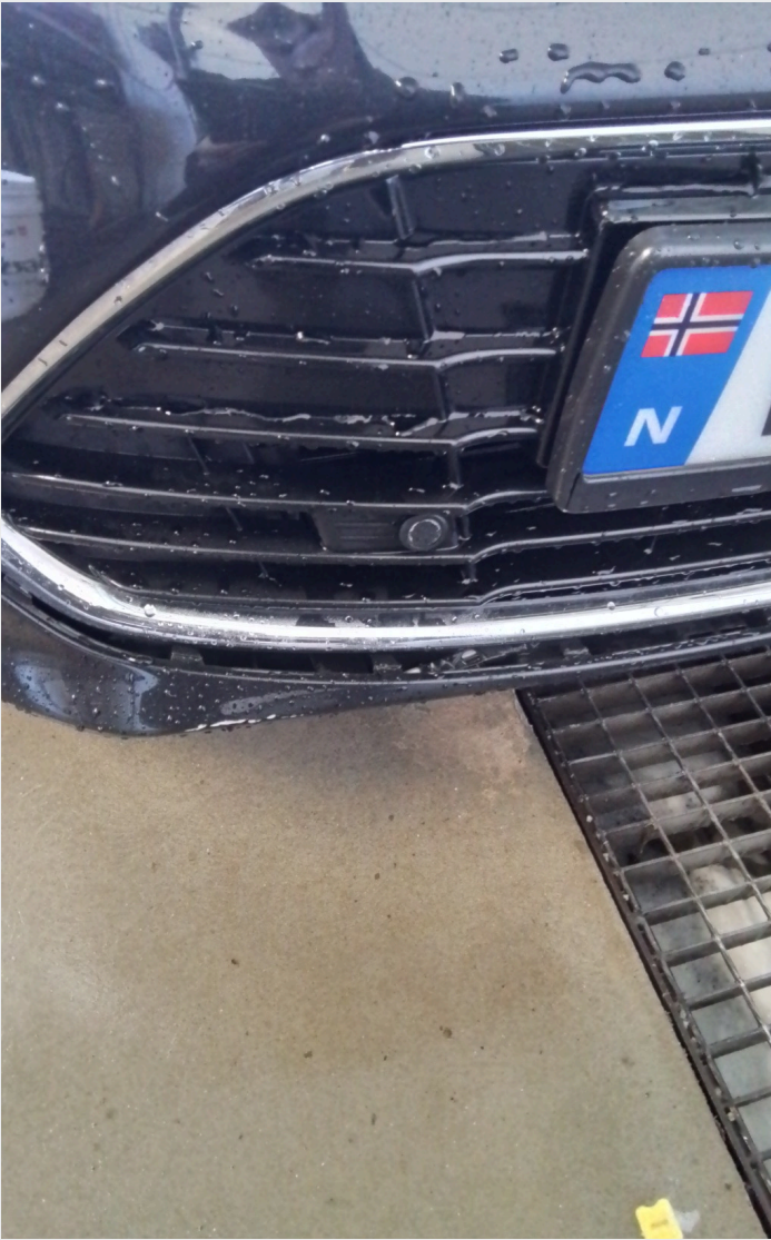
2.8 Nedre grill er litt inntrykt
