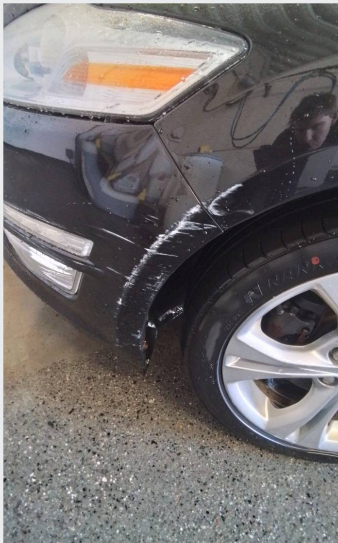
2.1 Lakkskade høyre side
