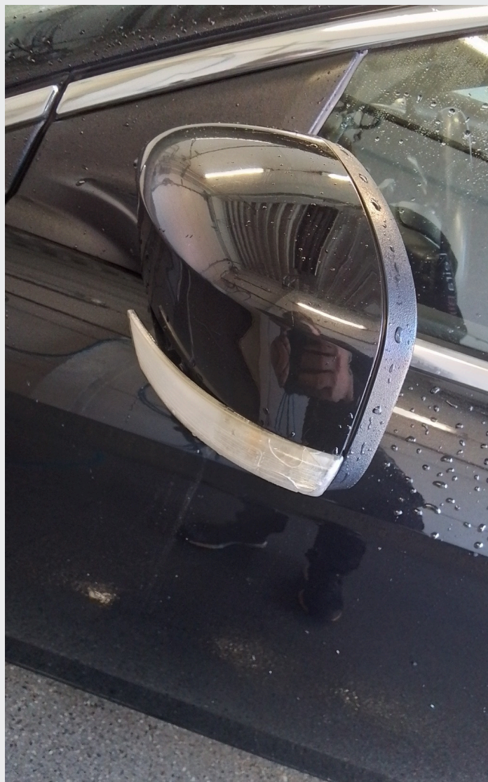
3.4 Blinklysglass speil venstre side er løs og sprekt
