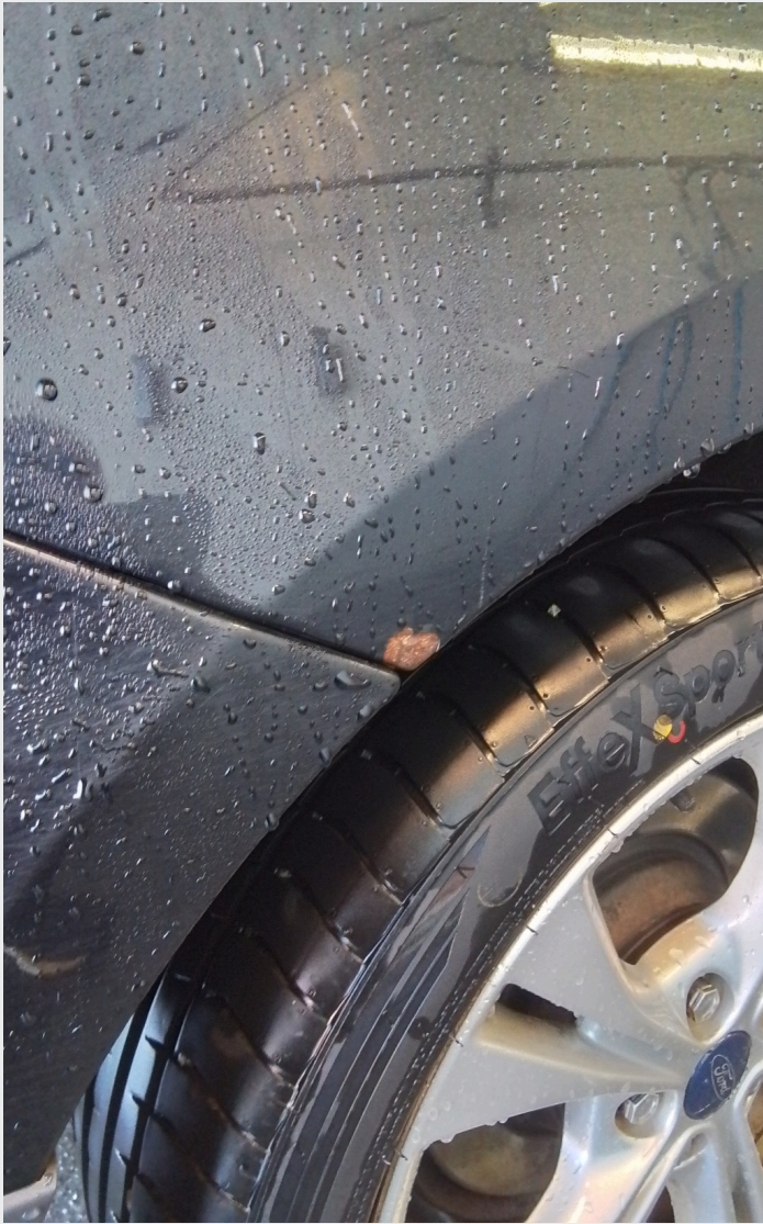
2.1 Noe rust i hjulbuer og nedre del av dører
