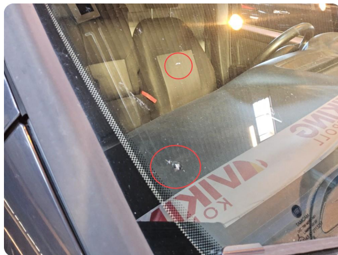
2.11 Steinsprut med sprekk
