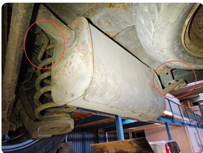
3.2 Mangler oppheng Defekt.
