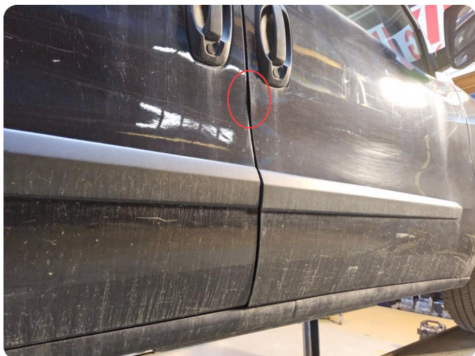
2.5 Øvrige feil Bulk/ ujevn ift dør bak.
