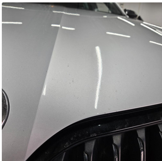
1.1 Div små steinsprutskader
