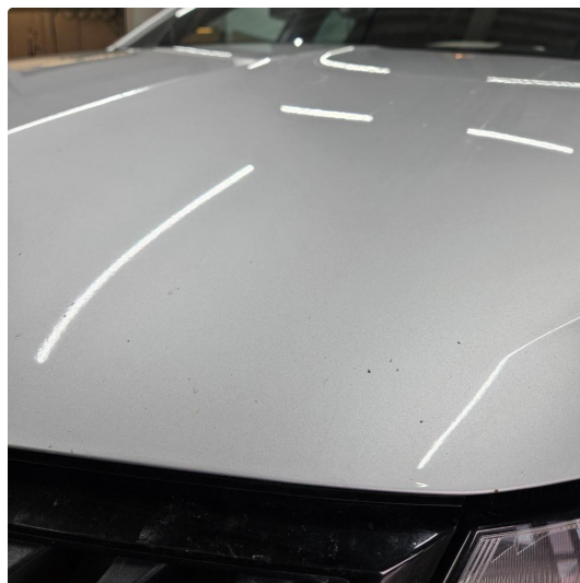
1.1 Div små steinsprutskader
