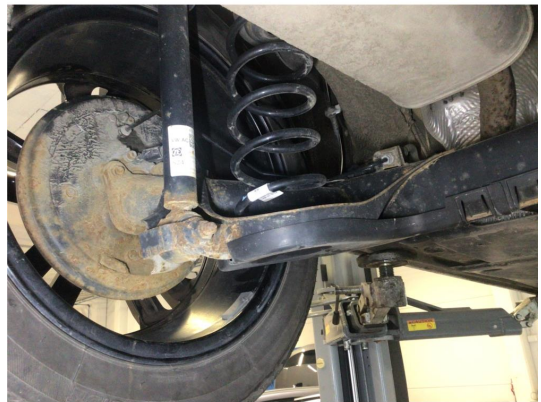
2.1 Noe overflaterust i bakstilling, ingen tiltak kreves
