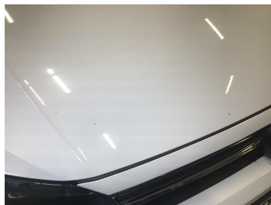
1.1 Steinsprut på panser
