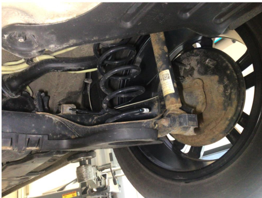
2.1 Noe overflaterust i bakstilling, ingen tiltak kreves
