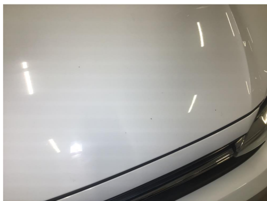
1.1 Steinsprut på panser
