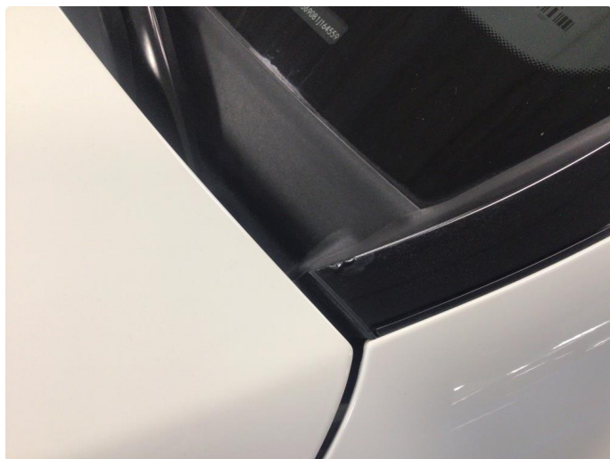
1.1 Noe bruksslitasje ved dørkanter og noen overfladiske riper på høyre bakdør. Litt påbegynnende korrosjon på lister ved frontvindu på hver side
