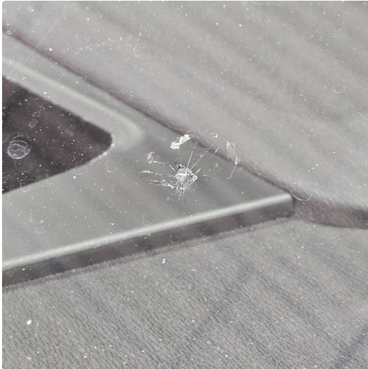
1.1 Steinsprut nede på v.side, blitt rep./limt, for info
