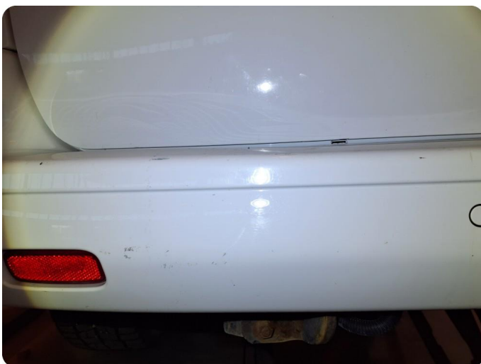
3.2 Generelt mye riper Riper, steinsprut, oppskrapet
