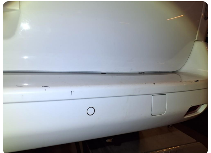
3.2 Generelt mye riper Riper, steinsprut, oppskrapet
