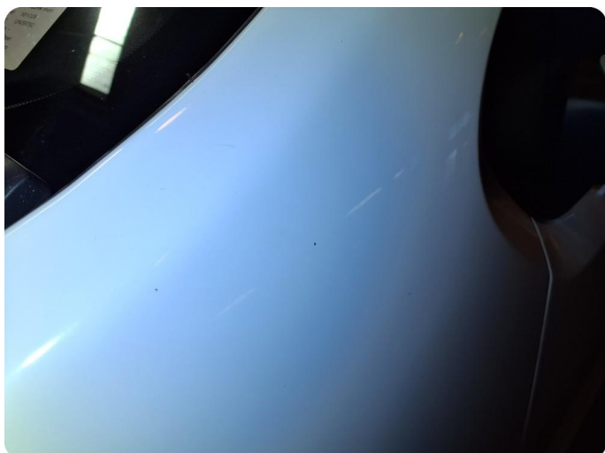
3.2 Generelt mye riper Riper, steinsprut, oppskrapet
