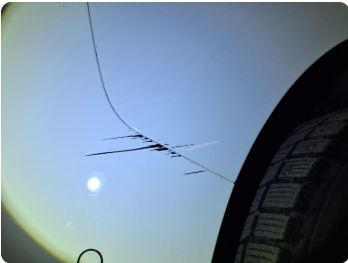
3.2 Generelt mye riper Riper, steinsprut, oppskrapet
