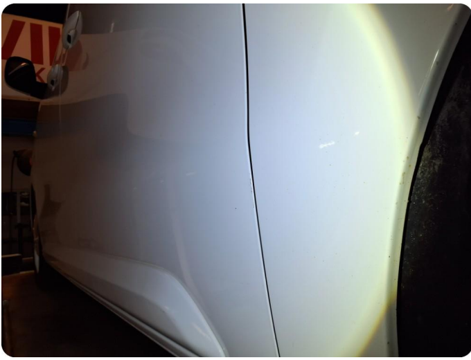
3.2 Generelt mye riper Riper, steinsprut, oppskrapet
