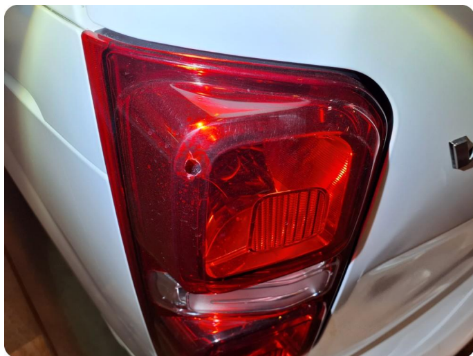
4.1 Defekt / sprukket glass
