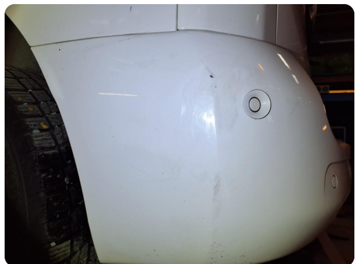
3.2 Generelt mye riper Riper, steinsprut, oppskrapet
