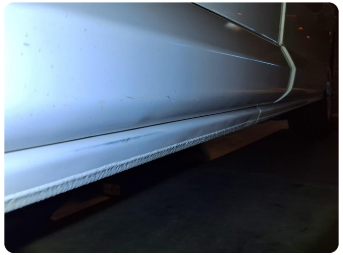
3.2 Generelt mye riper Riper, steinsprut, oppskrapet
