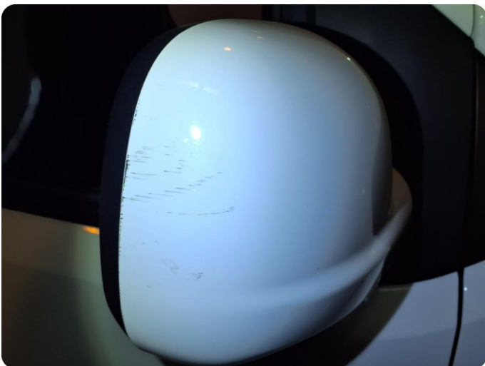
3.2 Generelt mye riper Riper, steinsprut, oppskrapet
