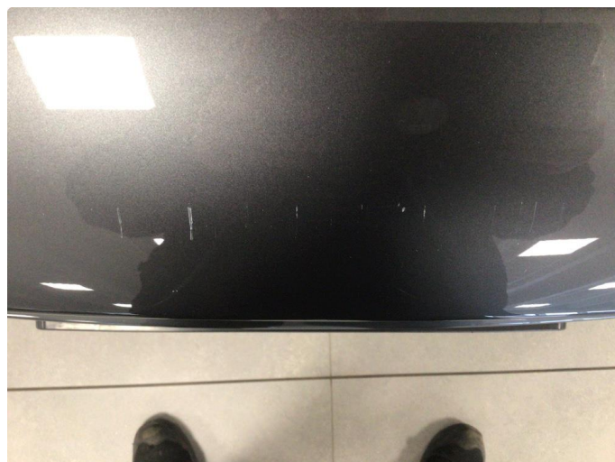
1.1 Noe overfladisk med riper og steinsprut på panser/panserforlenger og venstre bakdør.
