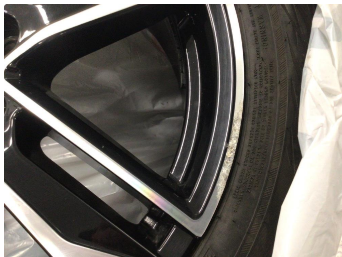
1.1 Noe påbegynnende oksidering på to vinterfelger, dette av ubetydelig karakter
