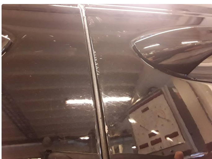
1.3 Noe riper og sår høyre foran.
