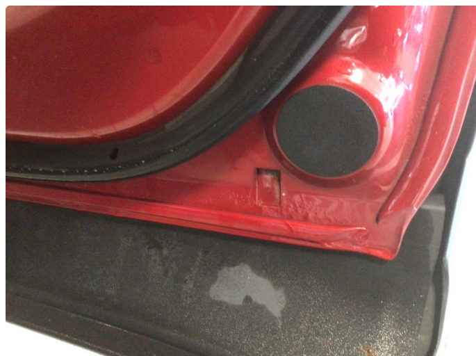
1.1 Noe påbegynnende korrosjon ved fals i dører blir utbedret
