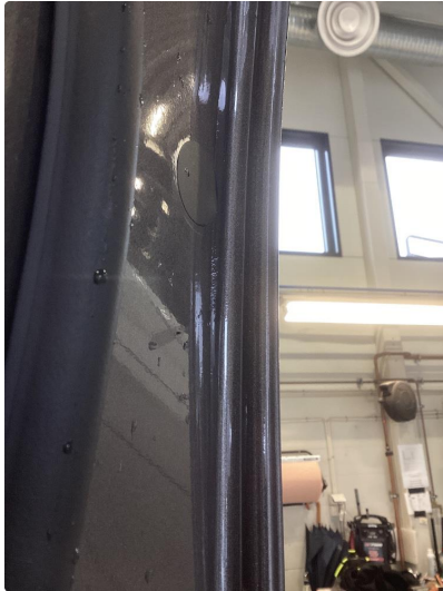
1.1 Rust i fals
