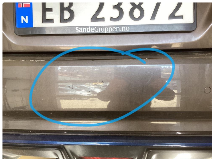
1.2 Ripe(r) ned til grunning
