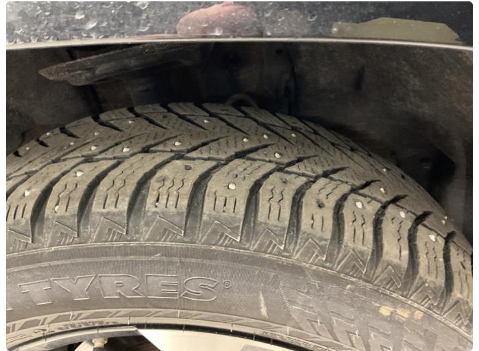
1.1 Piggdekk mangler pigger
