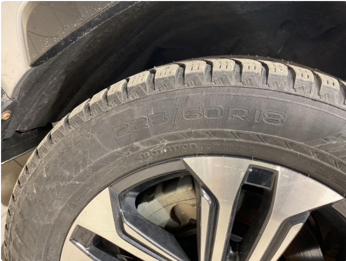
1.1 Piggdekk mangler pigger
