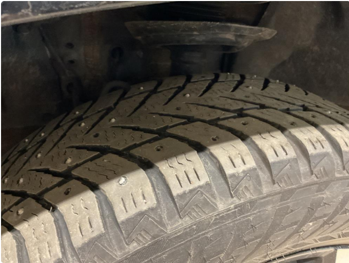
1.1 Piggdekk mangler pigger
