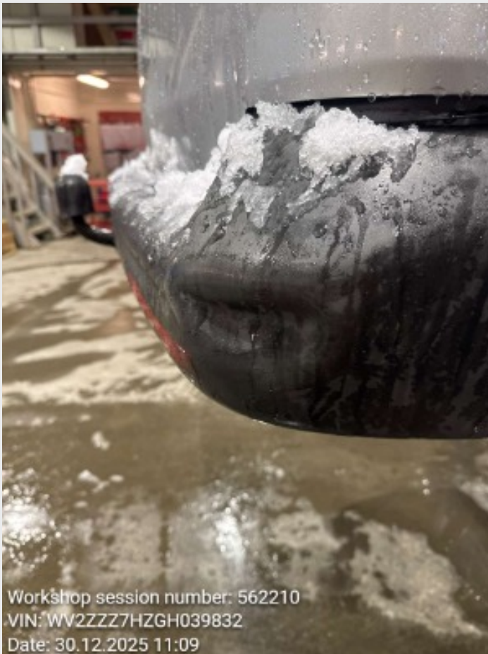
2.8 skade høyre side av bakfanger, bakfanger er løs
