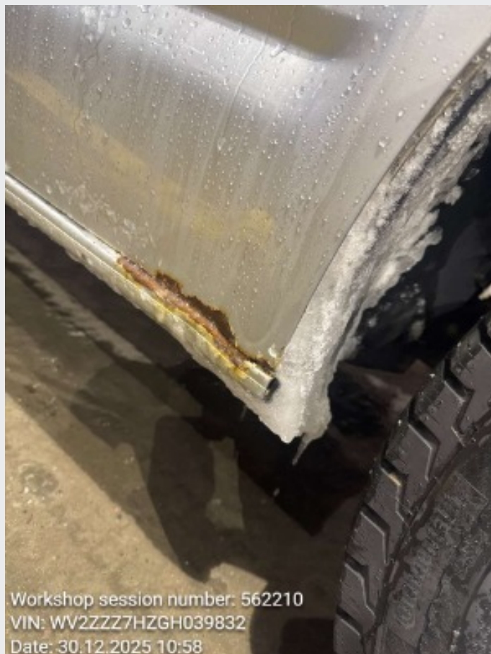
2.4 rust i fremkant av kanaler begge sider foran
