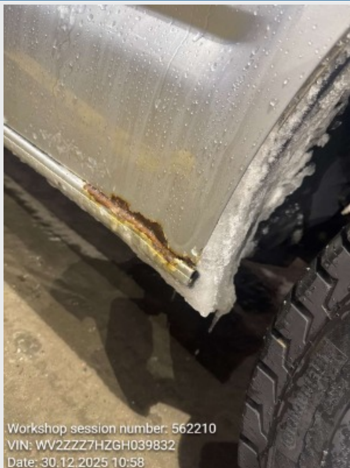
2.14 rust i topp av kanal høyre foran og i dør høyre foran i nedrekant
