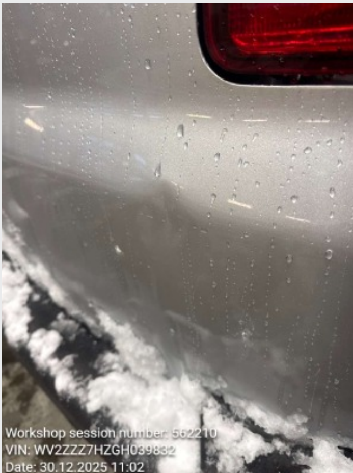
2.5 bulk bakluke høyre nedre bulk under glassrute høyre skyverdør
