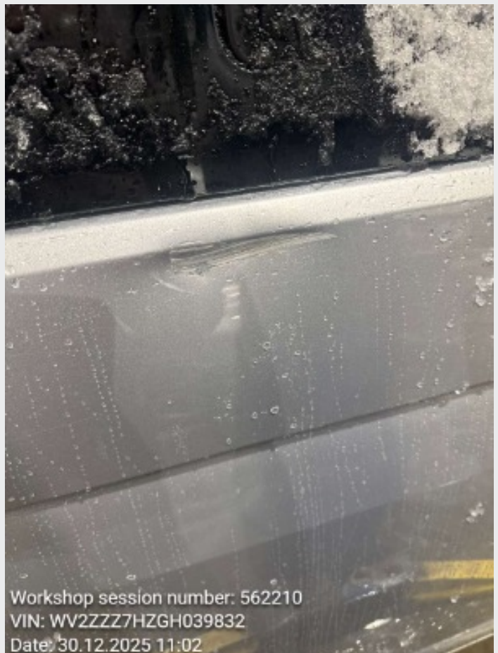
2.5 bulk bakluke høyre nedre bulk under glassrute høyre skyverdør
