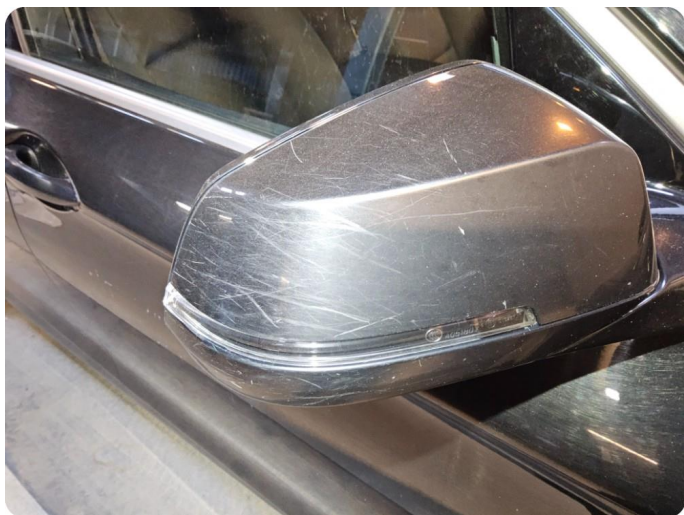
3.1 Generelt mye bruksslitasje / riper/ steinsprut. Hull i støtfangere etter lys.
