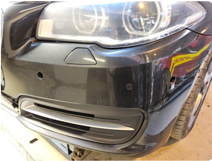
3.1 Generelt mye bruksslitasje / riper/ steinsprut. Hull i støtfangere etter lys.
