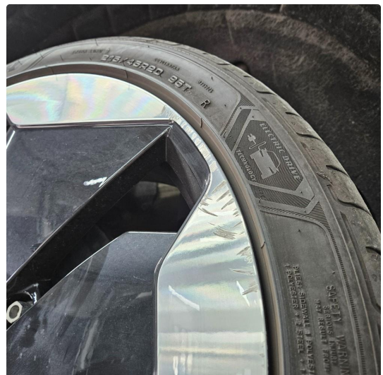
1.2 V.side bak, noe merker/riper på felg
