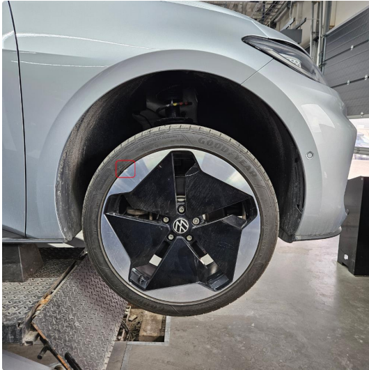
1.1 Liten skade/merke på felg, h.side foran (flenge på dekk er kun kosmetisk, cord synes ikke)
