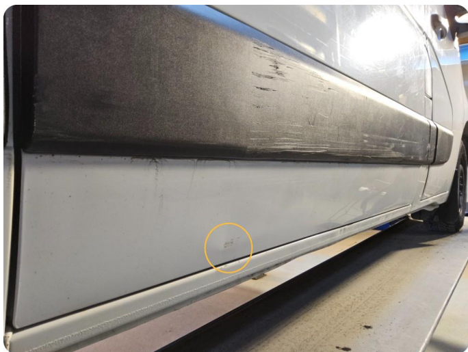
2.1 Generelt mye bruksslitasje Riper på de fleste flater og plastpaneler.
