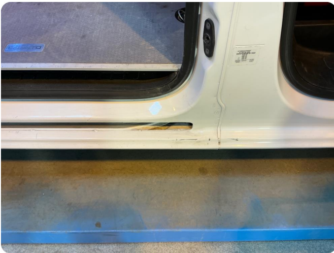
2.2 Slitt innsteg Slitt pga pakning som gnisser.
