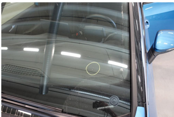
1.2 Steinsprut med liten sprekke, er limt.
