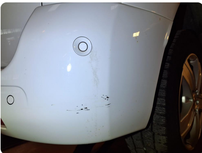
3.1 Generelt mye stensprut Og hakk/små riper
