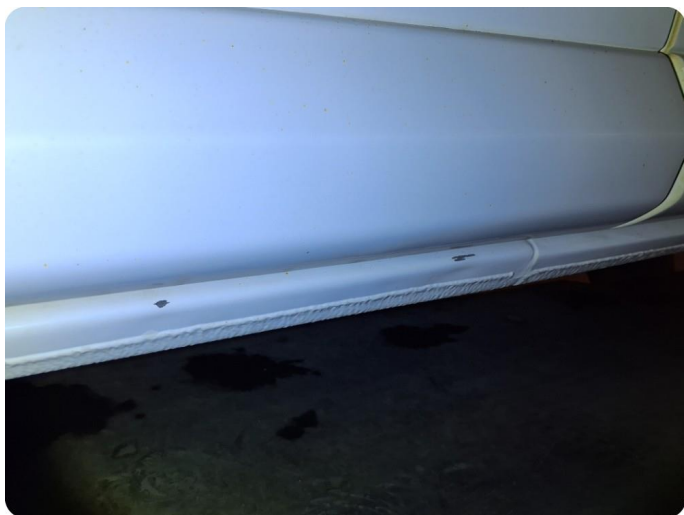
3.1 Generelt mye stensprut Og hakk/små riper
