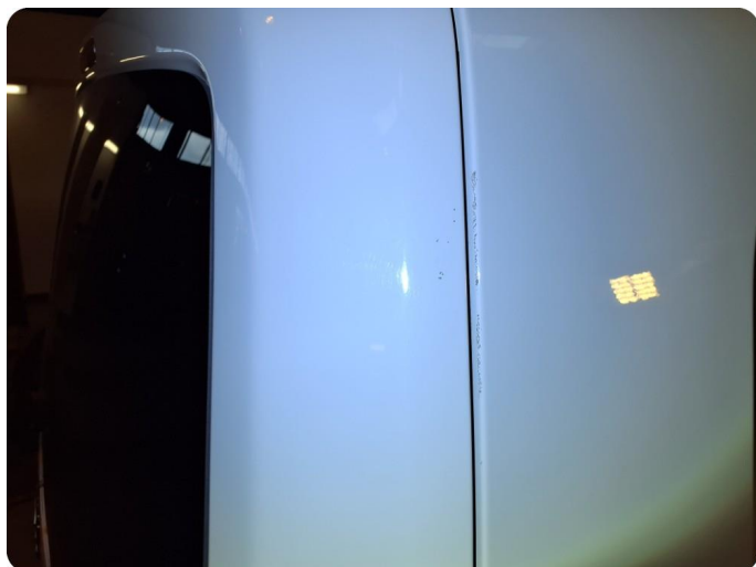
3.1 Generelt mye stensprut Og hakk/små riper
