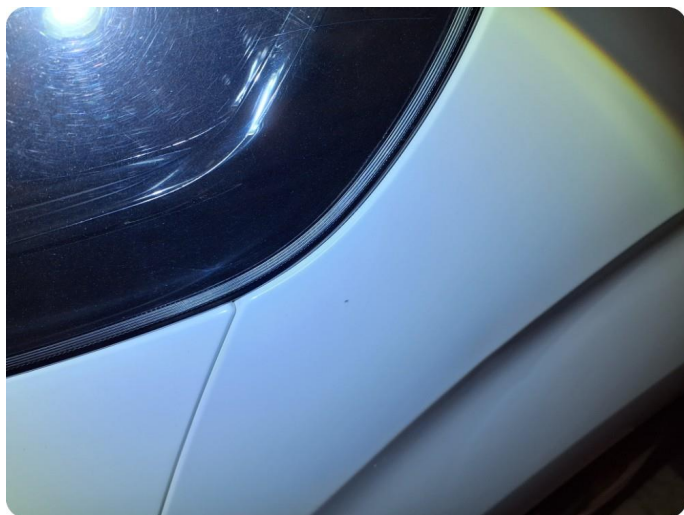
3.1 Generelt mye stensprut Og hakk/små riper
