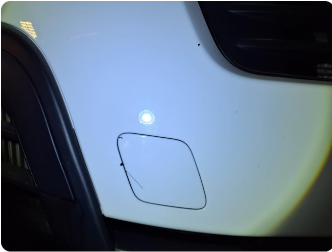
3.1 Generelt mye stensprut Og hakk/små riper
