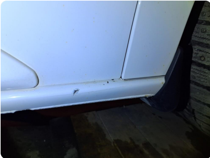
3.1 Generelt mye stensprut Og hakk/små riper
