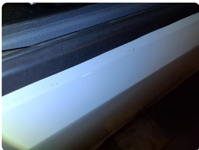
3.1 Generelt mye stensprut Og hakk/små riper
