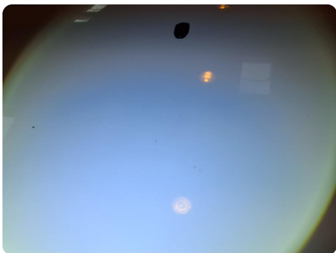
3.1 Generelt mye stensprut Og hakk/små riper
