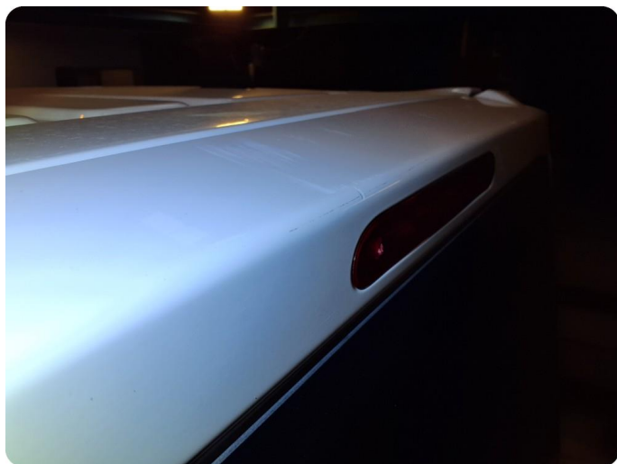
3.1 Generelt mye stensprut Og hakk/små riper
