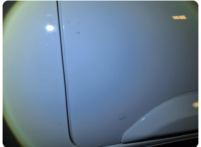
3.1 Generelt mye stensprut Og hakk/små riper
