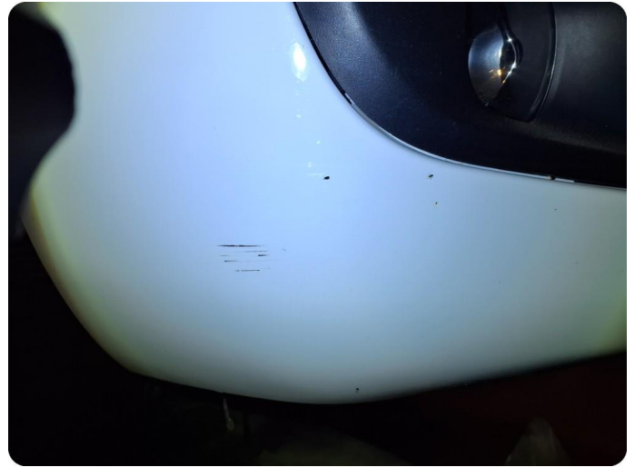
3.1 Generelt mye stensprut Og hakk/små riper
