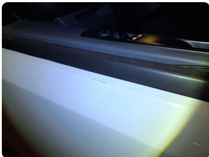
3.1 Generelt mye stensprut Og hakk/små riper
