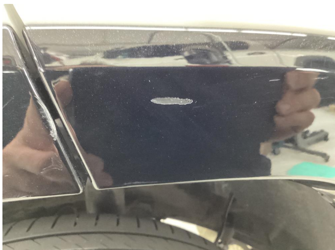
1.1 Svart deksel på høyre bakdør liten lakk skade
