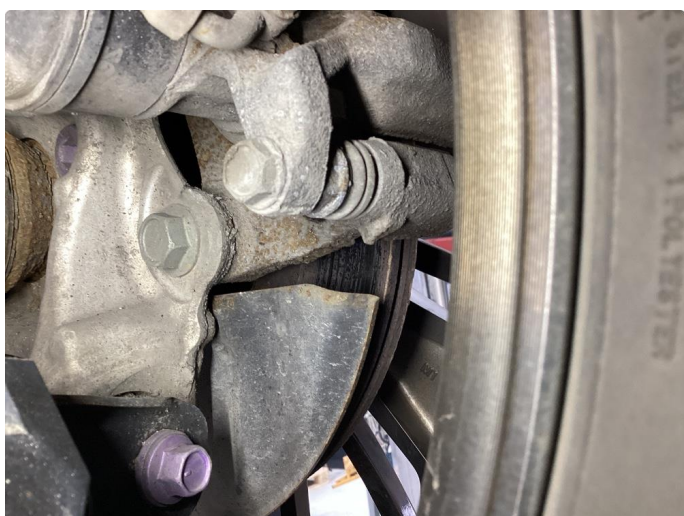
2.1 Noe overflate rust igjen etter prøvekjøring ber bremse mer for å få alt vekk
