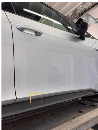
1.2 Liten steinsprut med korrosjon.
