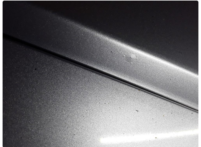
1.3 Liten steinsprut med korrosjon.
