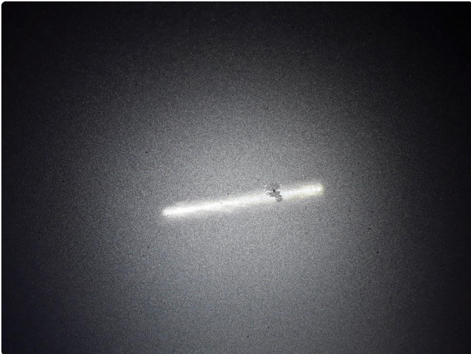
1.2 Liten steinsprut med korrosjon.
