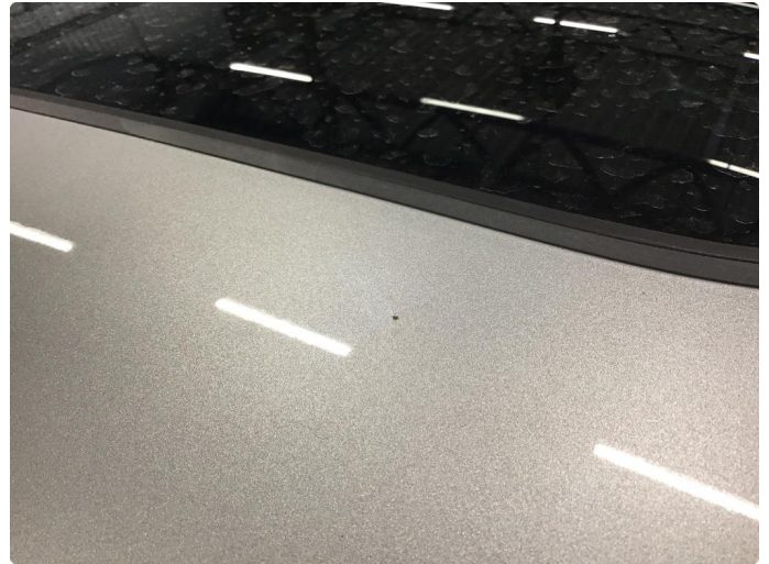
1.2 Steinsprut med rust
