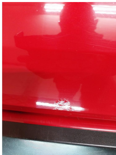
1.2 Steinsprut med rust
