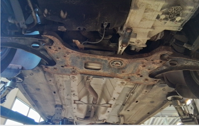
2.2 Rust travers foran og noe under bilen
