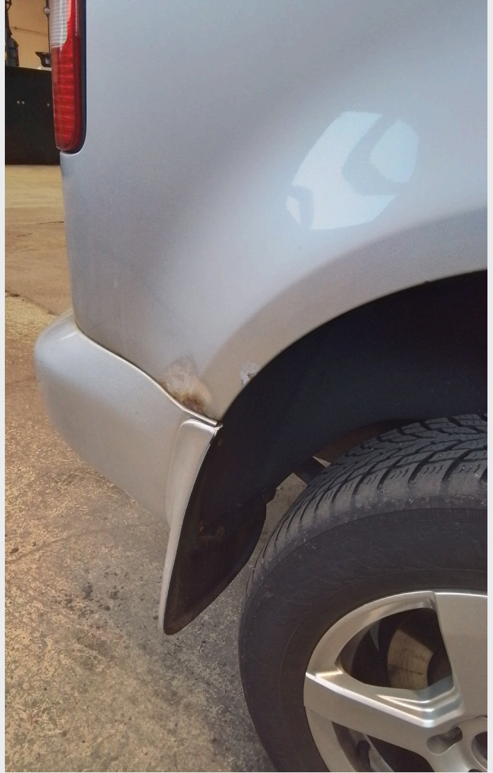
2.1 Div rust, bulker og skader
