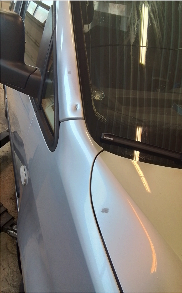
2.1 Div rust, bulker og skader
