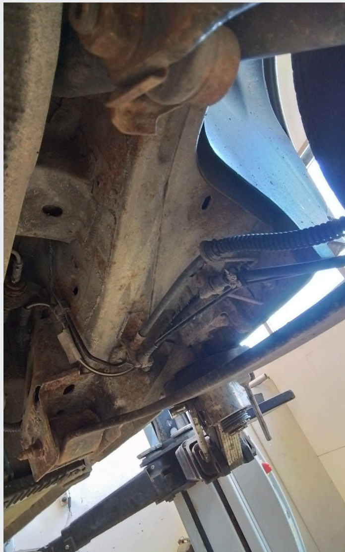
2.2 Rust travers foran og noe under bilen
