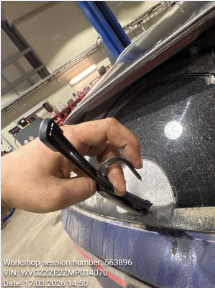
2.16 vindusvisker blad er ødelagt bak
