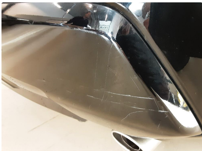
1.1 Ripe(r) ned til grunning
