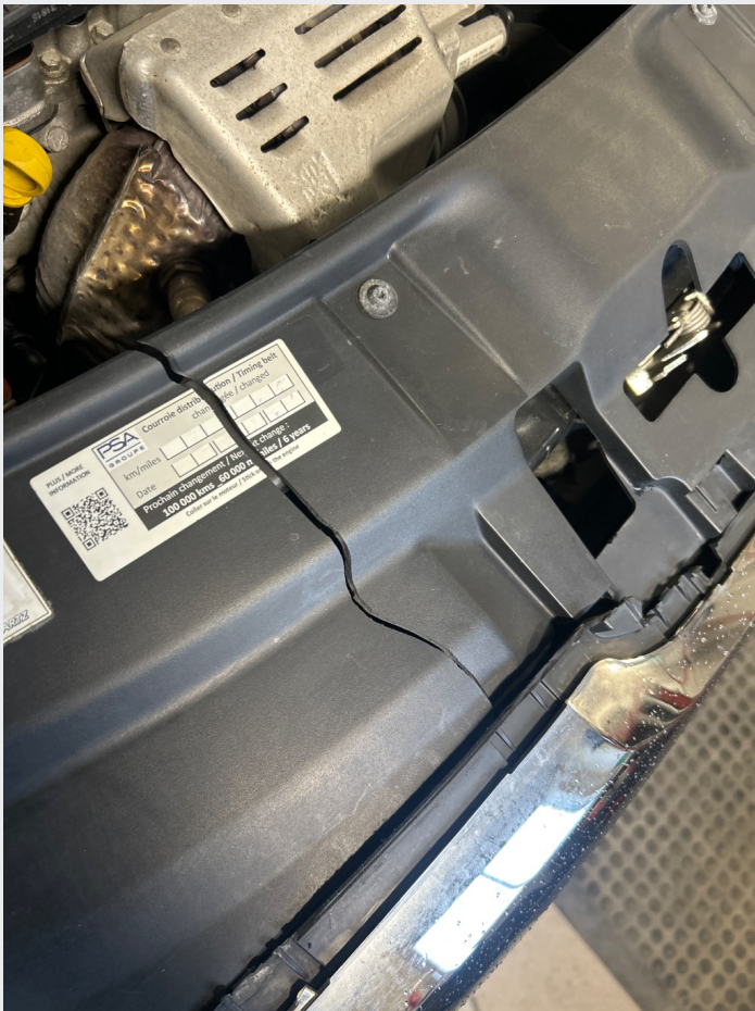
2.8 Deksel over grill, i motorrom, er knekt flere plasser
