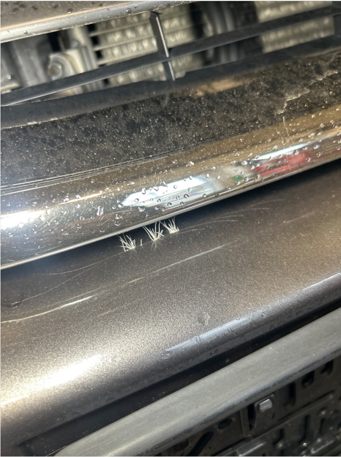
2.8 Grill i framfanger er løs på høyre side, ser ut som det er knekt flere plasser
