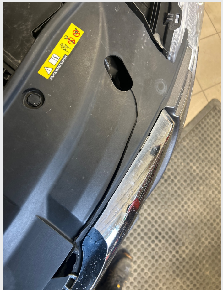
2.8 Deksel over grill, i motorrom, er knekt flere plasser
