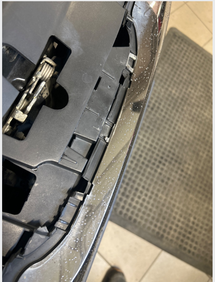
2.8 Grill i framfanger er løs på høyre side, ser ut som det er knekt flere plasser
