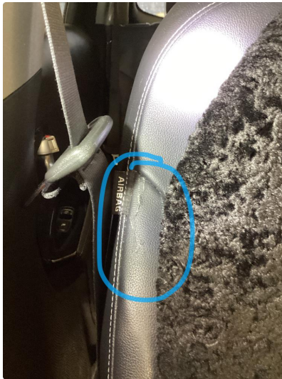
2.1 Skade på setetrekk
