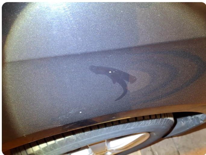
2.4 Steinsprut med rust
