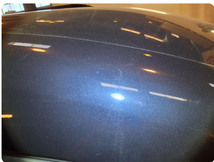
2.1 Generelt mye riper Og steinsprut
