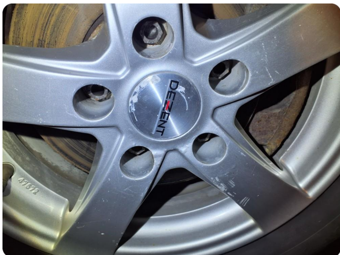
2.8 Kantkjørt felg +påbegynt oksidering (4vinter)
