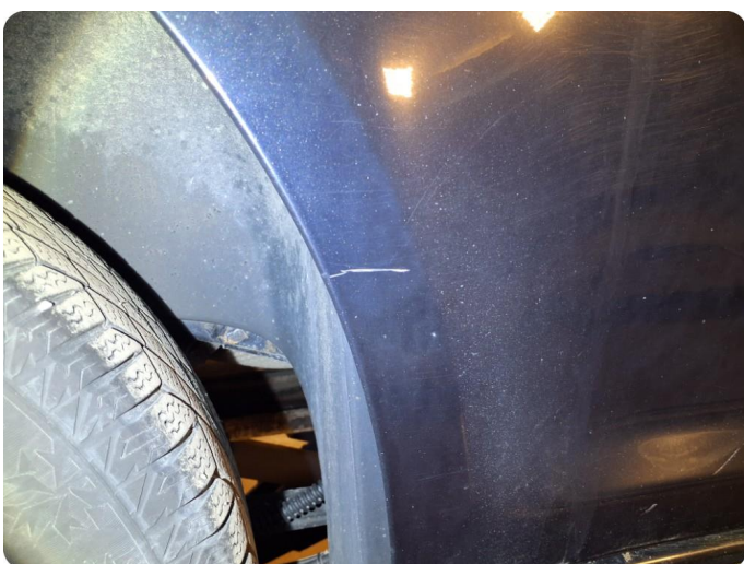
2.1 Generelt mye riper Og steinsprut
