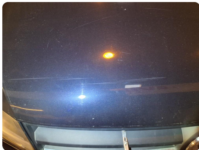
2.1 Generelt mye riper Og steinsprut
