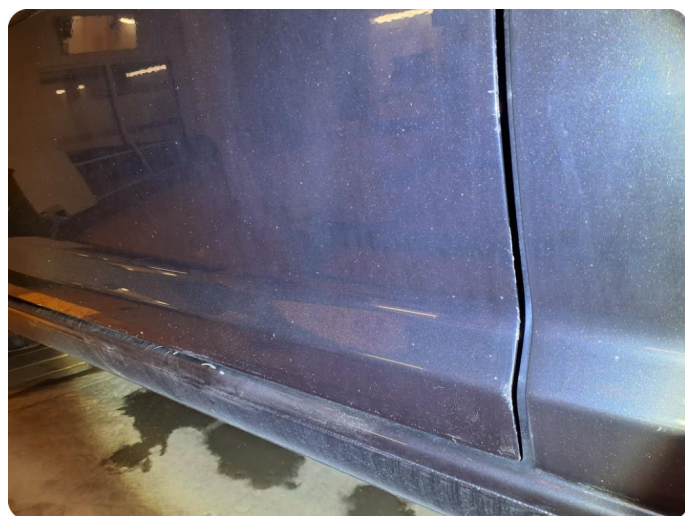
2.1 Generelt mye riper Og steinsprut
