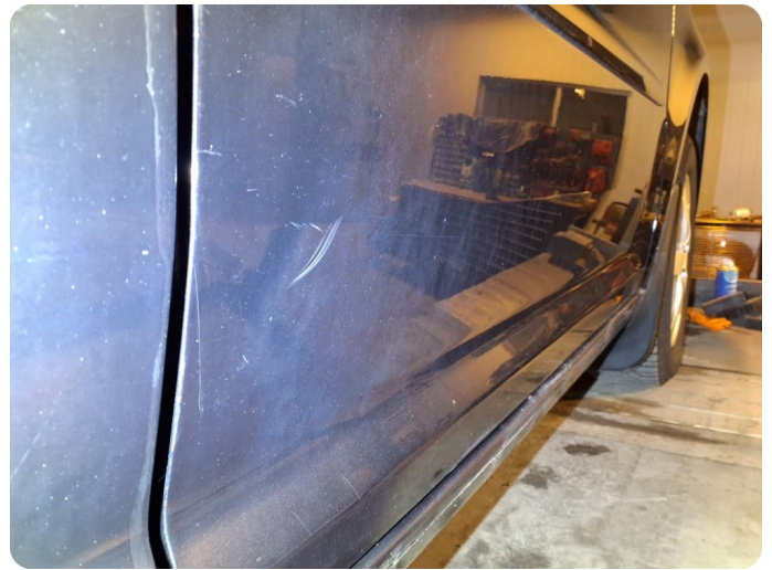
2.1 Generelt mye riper Og steinsprut
