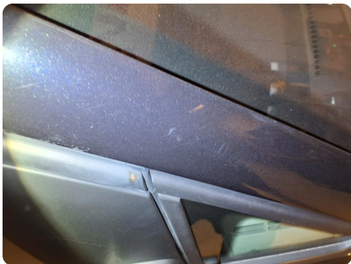
2.1 Generelt mye riper Og steinsprut
