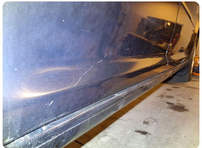
2.1 Generelt mye riper Og steinsprut
