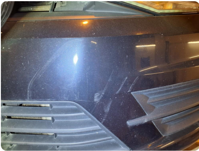
2.1 Generelt mye riper Og steinsprut
