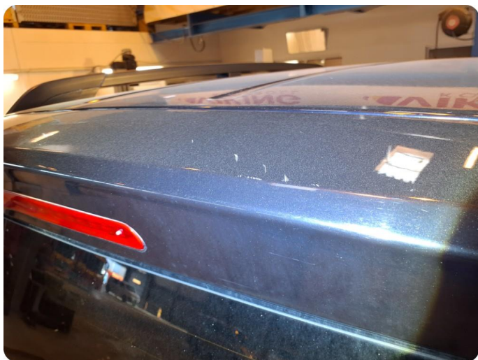
2.1 Generelt mye riper Og steinsprut
