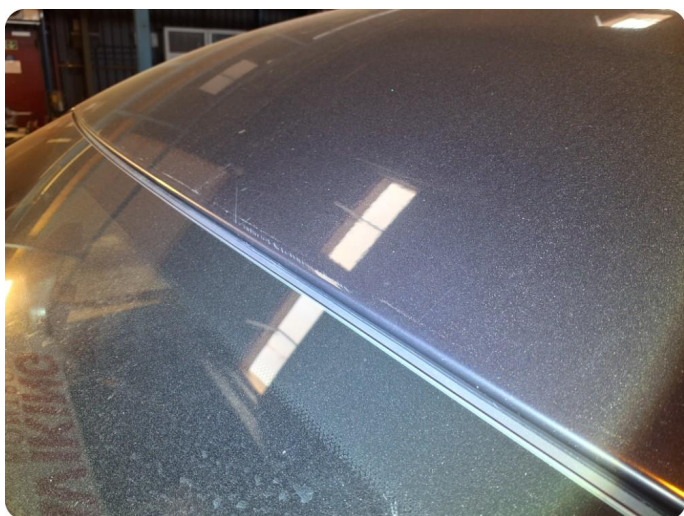
2.1 Generelt mye riper Og steinsprut
