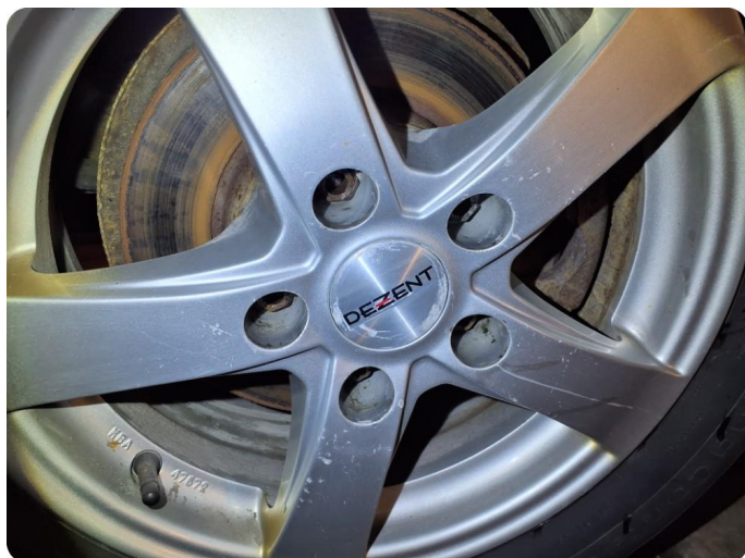
2.8 Kantkjørt felg +påbegynt oksidering (4vinter)
