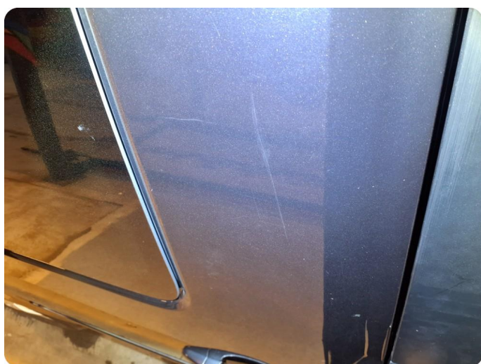
2.1 Generelt mye riper Og steinsprut
