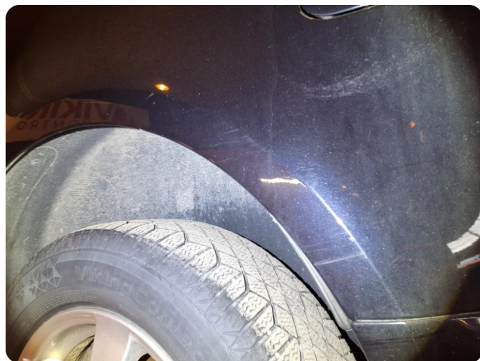
2.1 Generelt mye riper Og steinsprut
