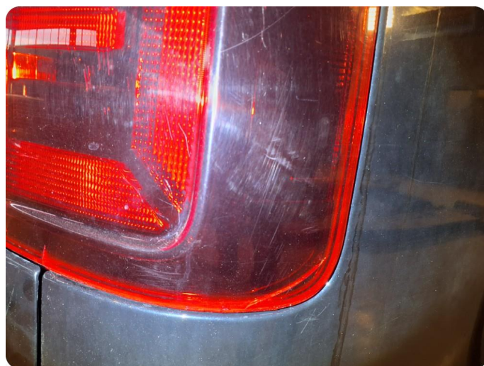
3.1 Defekt / sprukket glass
