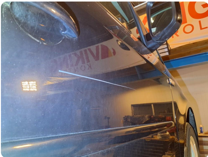
2.1 Generelt mye riper Og steinsprut
