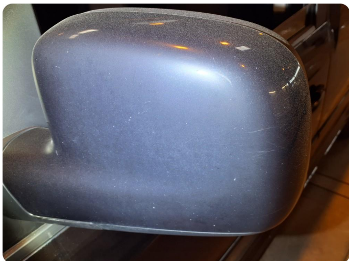
2.1 Generelt mye riper Og steinsprut
