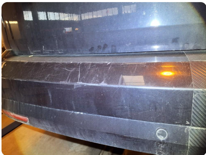
2.1 Generelt mye riper Og steinsprut
