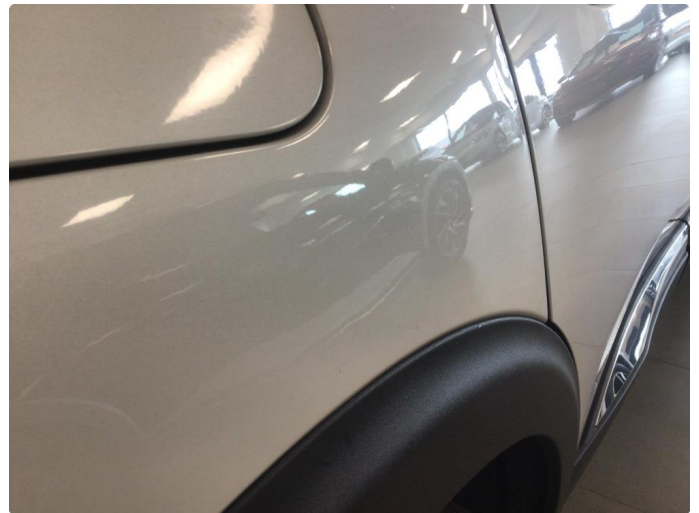
1.2 Noen små bulker på høyre bakskjerm, samt overfladiske riper som går over til høyre bakdør, dette av minimalt omfang.
