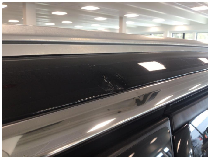
1.5 Liten bulk på takvange høyre side
