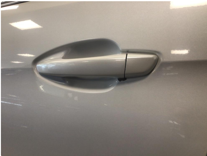
1.1 Litt lakkslepp under håndtak på venstre bakdør
