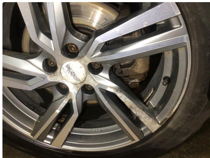
1.4 Noe oksidering på vinterfelger, dette av ubetydelig karakter
