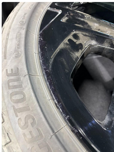
1.1 2stk kantkjørte sommerfelger har blitt penslet m/lakk. (Notert)
