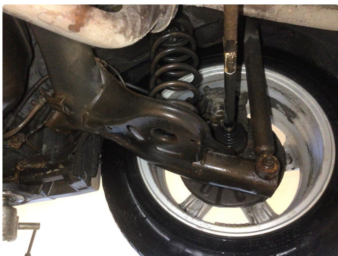
2.2 Overflaterust i bakstilling, ingen tiltak kreves
