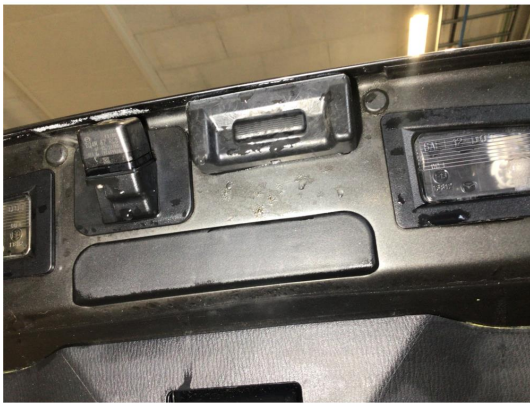
1.2 Minimalt med korrosjon på innsiden av bakluke, dette av ubetydelig karakter
