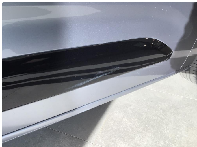
1.1 Noe overfladiske riper ved innlastingssone på bakfanger og dørlist høyre side framme, dette blir å anse som normal bruksslitasje
