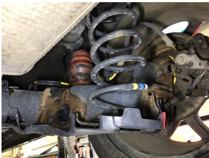
2.2 Overflaterust i bakstilling, ingen tiltak kreves
