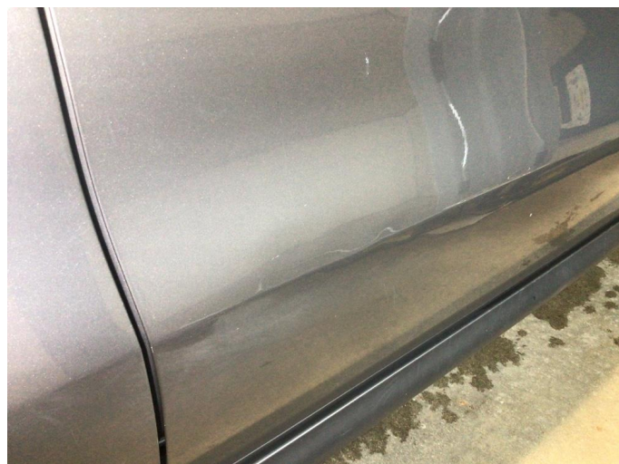
1.1 Små bulker på høyre framdør, dette av begrenset omfang og av ubetydelig karakter
