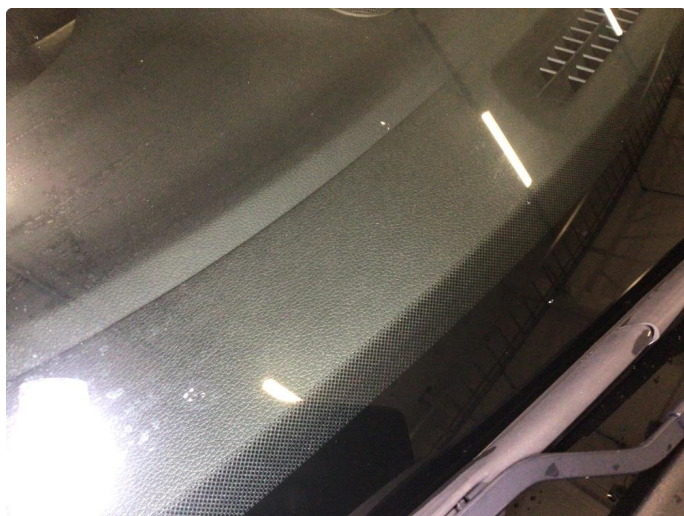
1.4 Noe steinsprut på frontvindu
