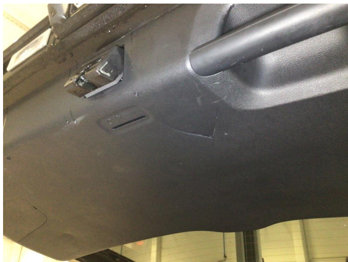
1.2 Liten sprekk i bagasjeromsdeksel
