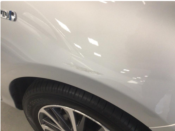
1.1 Noe riper på høyre side av bak og frontfanger, samt høyre framskjerm. Små bulker med noe overfladisk korrosjon på kanal høyre side og noe bruksmerker ved innlastingszone på bakfanger
