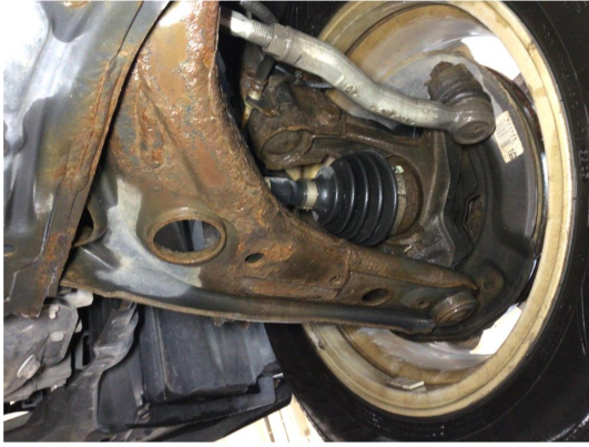
2.1 Overflaterust i forstilling, ingen tiltak kreves
