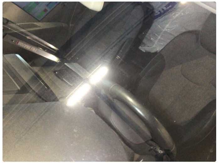
1.2 Noe slitasjeriper på frontvindu
