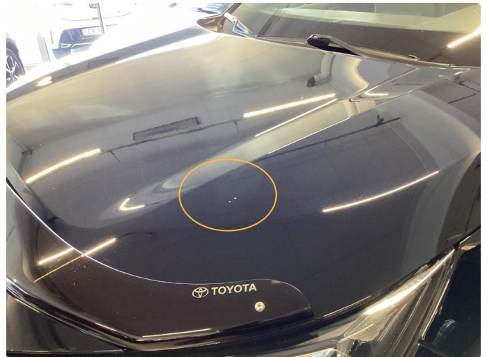
1.2 Div steinsprut panser
