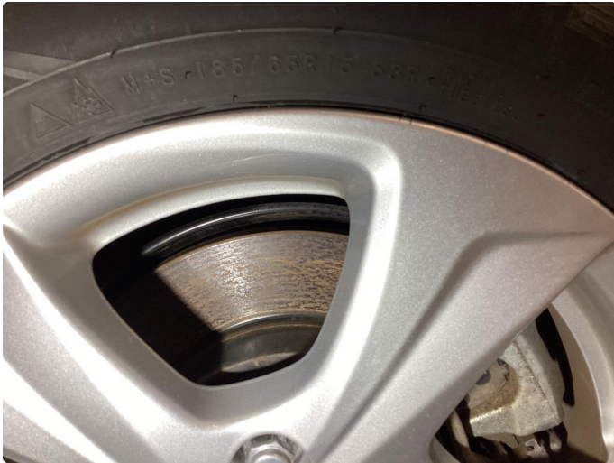
1.1 Rust. KJØRES RENE NÅR BILEN TAS I BRUK.
