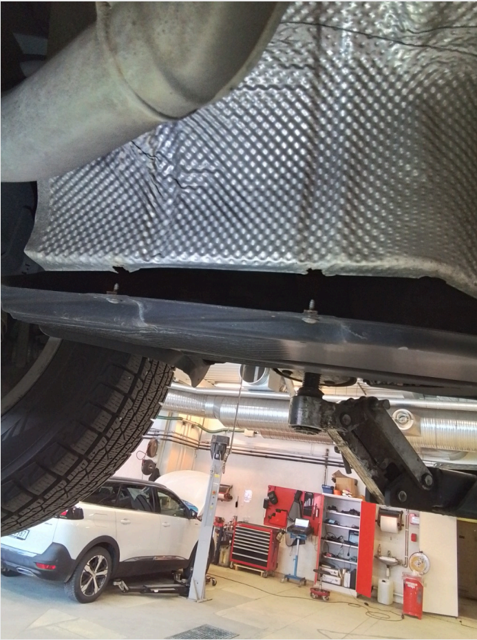
2.2 Div skader plater under bil
