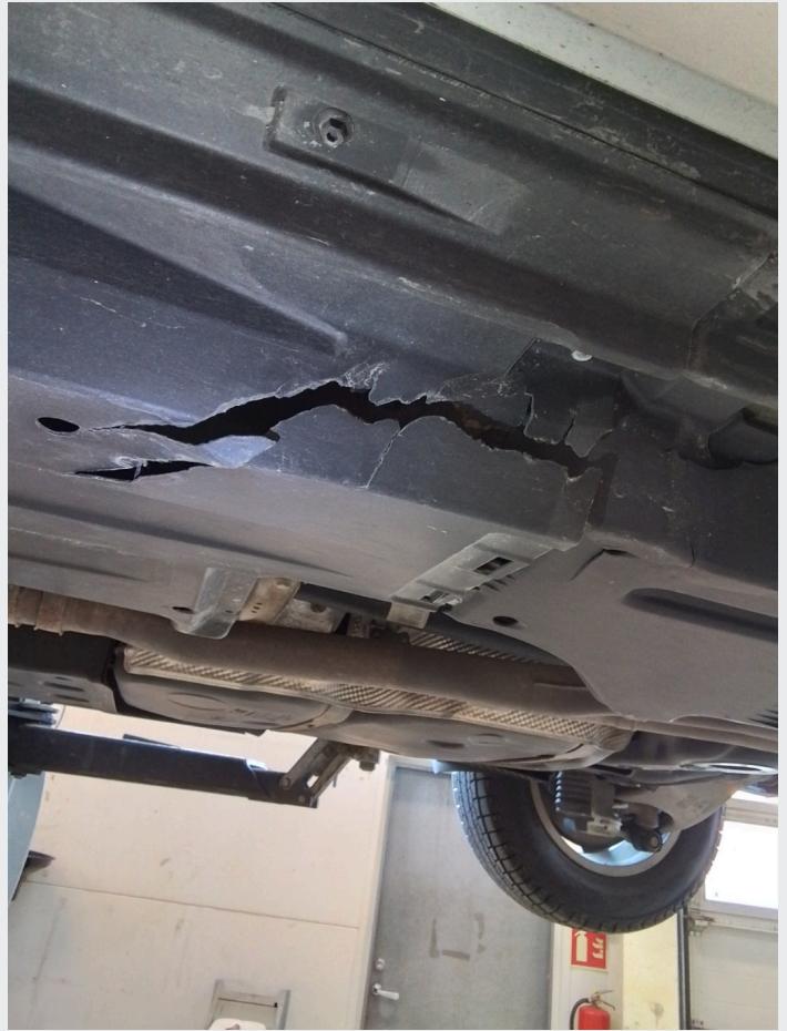
2.2 Div skader plater under bil
