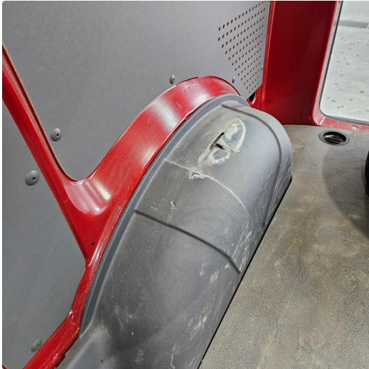
2.1 Hull på deksel over hjulhus i varerom. Notert
