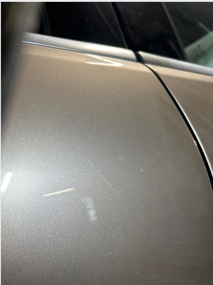
2.1 En del riper og steinsprut rundt om
